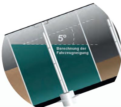
Das Peilstabsystem von DEZIDATA TVE arbeitet vollelektronisch im Tankfahrzeug
